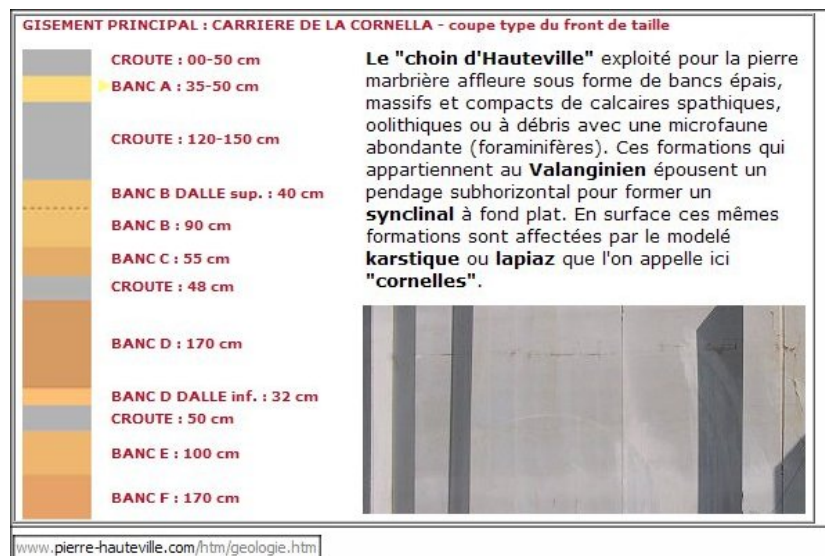
Figure 26 : coupe du front de taille de la carrière d'Hauteville (document Entreprise Vincent).
